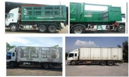
ภาพรถบรรทุกที่มีกระบะข้าง แบบบานพับ ใช้ขนส่ง Waste ประเภท กากของเสียที่บรรจุอยู่ใน IBCs, Drum สำหรับรถบรรทุกประเภทตู้คอนเทนเนอร์ ใช้ขนส่งแบบเตอรีใช้แล้ว, อุปกรณ์ไฟฟ้าใช้แล้ว, กากของเสียไม่อันตราย เป็นต้น
