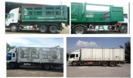
ภาพรถบรรทุกที่มีกระบะข้าง แบบบานพับ ใช้ขนส่ง Waste ประเภท กากของเสียที่บรรจุอยู่ใน IBCs, Drum สำหรับรถบรรทุกประเภทตู้คอนเทนเนอร์ ใช้ขนส่งแบบเตอรีใช้แล้ว, อุปกรณ์ไฟฟ้าใช้แล้ว, กากของเสียไม่อันตราย เป็นต้น
